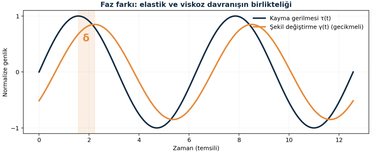
Şekil 4. Sinüzoidal gerilme ile deformasyonun faz farkı; şematik sinyaller gerçek deney sonucu değildir.
